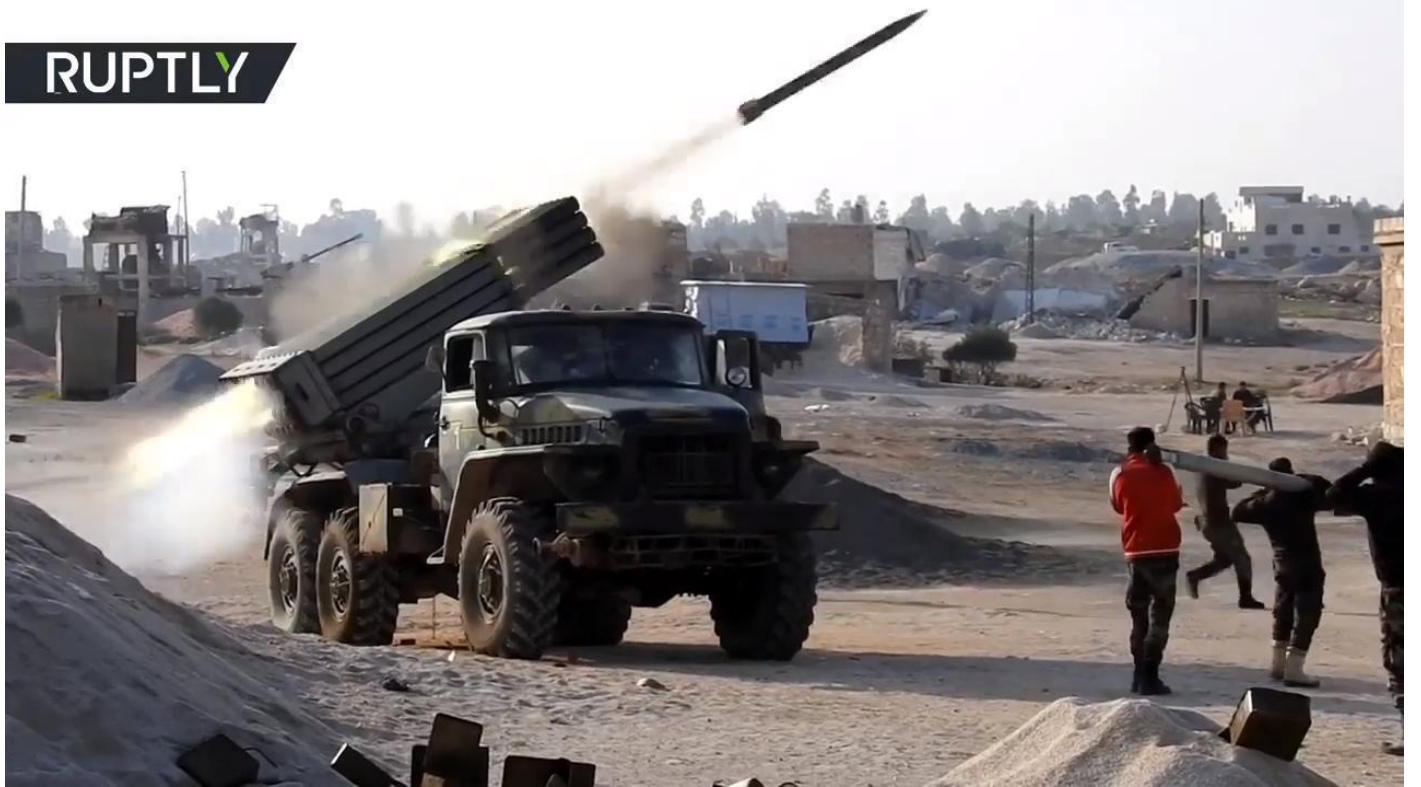
صورة رقم (9) - مثال عن تثبيت صواريخ "غراد نوع BM - 21" على ظهر إحدى الشاحنات العسكرية التابعة للجيش النظامي السوري. وهي الطريقة التي يتم استخدام الصواريخ فيها عادة.
